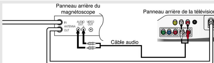
Si vous avez un magnétoscope "mono" (c'est-à-dire qu'il n'est pas stéréo), utilisez le connecteur Y (non fourni) pour le brancher aux prises d'entrée audio droite et gauche de la télévision. Si votre magnétoscope est stéréo, vous devez brancher deux câbles.
