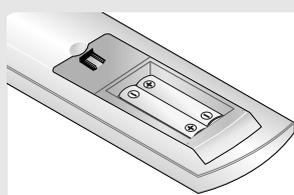
◀ Assurez-vous de faire correspondre les pôles “ + ” et “ - ” des piles avec le schéma situé à l’intérieur du compartiment.
