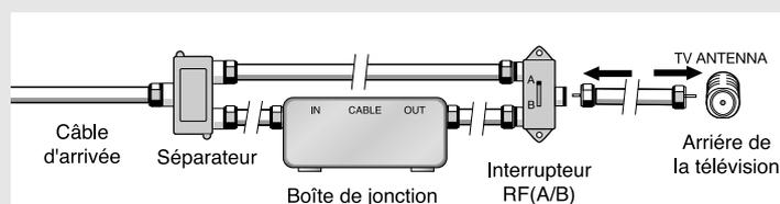
Après avoir établi cette connexion, réglez l'interrupteur A/B en position "A" pour regarder les chaînes normales. Placez l'interrupteur A/B en position "B" pour une regarder les chaînes cryptées. (Lorsque vous placez l'interrupteur A/B sur "B", vous devez syntoniser votre télévision sur la chaîne de sortie de la boîte de jonction qui est habituellement la chaîne 3 ou 4.)
