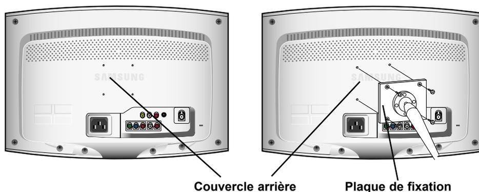
Alignez la plaque de l'interface de montage avec les trous de la plaque de fixation du couvercle arrière et bloquez-la à l'aide des quatre vis fournies avec la base type bras, avec le dispositif de fixation au mur ou avec les autres bases.
