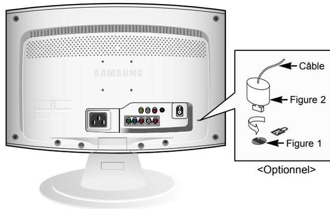
Le verrouillage Kensington est un dispositif utilisé pour fixer physiquement le système dans le cas d'une utilisation dans un endroit public. Le dispositif de verrouillage doit être acheté séparément. L'aspect et la méthode de verrouillage peuvent différer de l'illustration en fonction du fabricant. Reportez-vous au manuel fourni avec le verrouillage Kensington pour une utilisation correcte.
