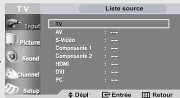
◀ Si le connecteur n'est pas branché, aucune source, à part la télévision, ne peut être sélectionnée. (à la fois dans l'écran principal et dans l'écran secondaire).
