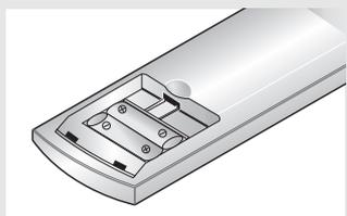
◀ Assurez-vous de faire correspondre les pôles “+” et “-” des piles avec le schéma situé à l’intérieur du compartiment.
