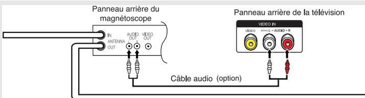
Si vous avez un magnétoscope "mono" (c'est-à-dire qu'il n'est pas stéréo), utilisez le connecteur Y (non fourni) pour le brancher aux prises d'entrée audio droite et gauche de la télévision. Si votre magnétoscope est stéréo, vous devez brancher deux câbles.
