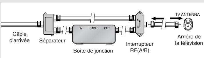
Après avoir établi cette connexion, réglez l'interrupteur A/B en position " A " pour regarder les chaînes normales. Placez l'interrupteur A/B en position " B " pour une regarder les chaînes cryptées. (Lorsque vous placez l'interrupteur A/B sur " B ", vous devez syntoniser votre télévision sur la chaîne de sortie de la boîte de jonction qui est habituellement la chaîne 3 ou 4.)
