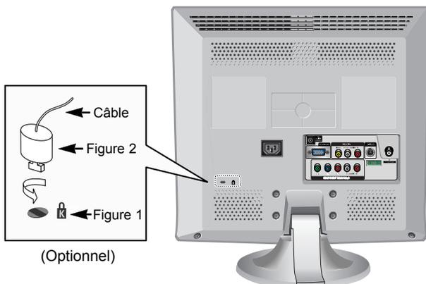
Le verrouillage Kensington est un dispositif utilisé pour fixer physiquement le système dans le cas d'une utilisation dans un endroit public. Le dispositif de verrouillage doit être acheté séparément. L'aspect et la méthode de verrouillage peuvent différer de l'illustration en fonction du fabricant. Reportez-vous au manuel fourni avec le verrouillage Kensington pour une utilisation correcte.
