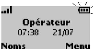
Pendant la charge, les trois sections de l'icône de batterie clignotent alternativement. Une fois que la charge est terminée, les trois sections de l'indicateur de batterie restent affichées. Le voyant lumineux n'est pas utilisé comme indicateur si le téléphone est allumé. Si un appel est reçu pendant la charge, le voyant lumineux devient vert et clignote rapidement.
