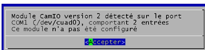
Les entrées sont numérotées E0 à E7 ou E0 et E1 (sur le boîtier deux voies). Elles sont déclenchées par des contacts secs. Pour tester l'entrée E0, il faut court circuiter les deux bornes E0, pour tester l'entrée E1, les deux bornes, E1, etc. Les deux bornes d'un contact sont situées côte à côte.
