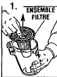
Appuyez sur le loquet du godet à poussière. Secouez le godet à poussière vers le bas pour le retirer de l'unité. Saisissez la languette et retirez l'ensemble filtre du godet à poussière.
