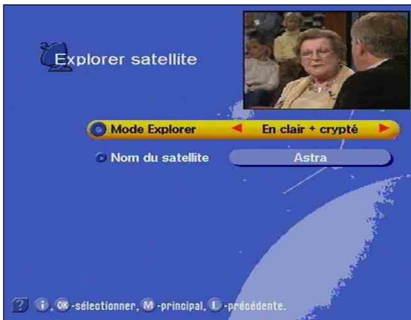
menu avec les touches . Dans la première ligne, vous sélectionnez avec ou si la recherche portera sur des chaînes diffusées en clair ou sur des chaînes diffusées en clair et des chaînes cryptées. Vous sélectionnez le satellite voulu avec les touches ou . La recherche est lancée ensuite avec .
