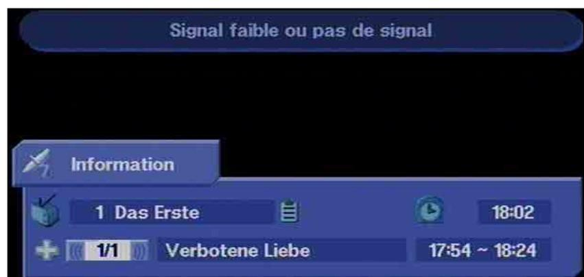
Le texte "Signal faible ou pas de signal" indique que l'installation de réception présente un défaut ou que les réglages du récepteur ne sont pas corrects ou que le transpondeur n'émet pas. L'indication de canal montre à la place **i** un **antenne** satellite. Vérifiez la connexion FI Sat. et la configuration du LNB. Pour ce faire, aidez-vous de la liste des réglages au chapitre Service à la fin de ce mode d'emploi.
