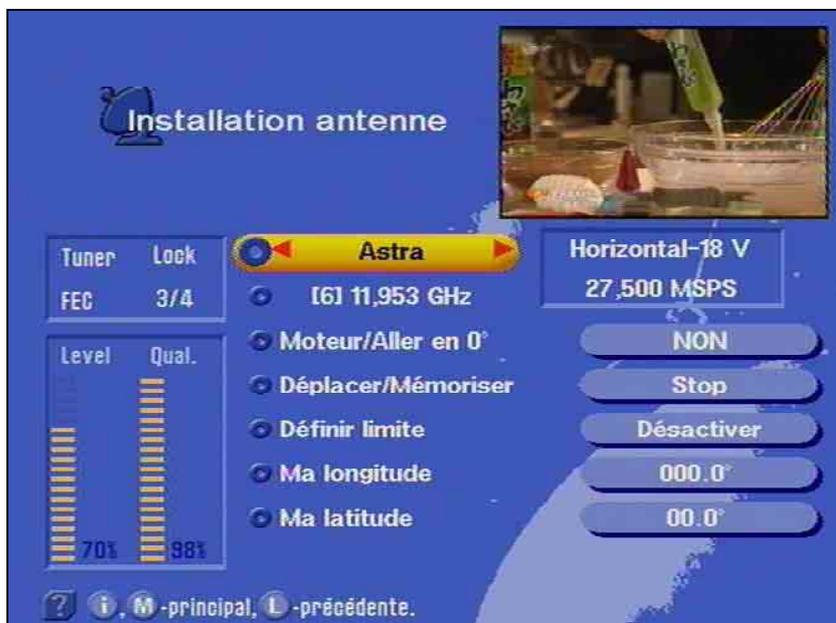
La première ligne permet de déterminer le satellite et la deuxième ligne le transpondeur.
