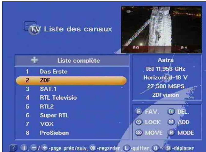
En haut à gauche un + indique qu'il s'agit de la liste complète. Dans la colonne en dessous, vous recevez des informations sur le canal, le nom de la chaîne et si la chaîne est habituellement cryptée. Dans le haut de la colonne de droite sont affichées des informations sur le satellite reçu, le transpondeur et sa fréquence ainsi que la polarisation. Vous sélectionnez la chaîne voulue avec la barre de curseur ou les touches numériques et confirmez votre choix avec la
