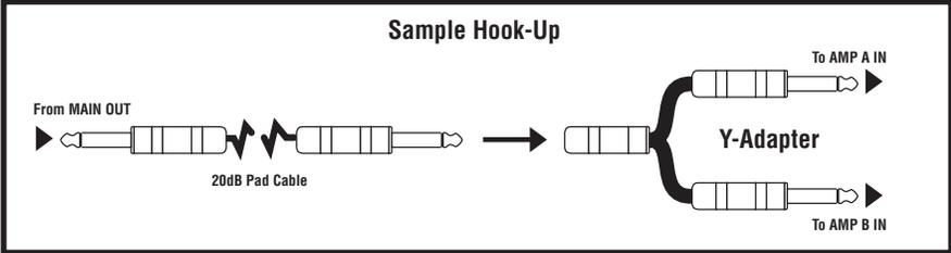
**\*\* Pour fabriquer les câbles atténuateurs (- 20dB) de raccordement, commencez avec des câbles de raccordement blindés courts. Sur chaque câble, soudez une résistance de 10k Ohm en série avec la pointe de la prise à être insérée dans le jack LINE OUT. Soudez ensuite une résistance de 2.2k Ohm à travers la prise à être insérée dans le jack AMP IN. Nous vous recommandons d'identifier l'une ou l'autre des extrémités de chaque câble.**
