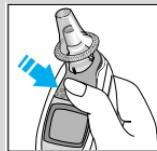
O termómetro Braun ThermoScan desliga automaticamente se não for utilizado durante 60 segundos. Pode também ser desligado, premindo-se o botão «I/O» durante pelo menos 3 segundos. No mostrador aparece brevemente, de maneira intermitente, «OFF» e fica iluminado de maneira permanente após a soltura da tecla.
