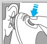
Si la sonda se ha colocado correctamente en el canal auditivo, una señal acústica de larga duración confirma el final de la medición. En este momento puede estar seguro de que ha medido su temperatura con precisión. El resultado aparece en la pantalla.
