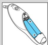
Abra el compartimento de las pilas. Retire las pilas y sustitúyalas por pilas nuevas asegurándose de que los polos están en la posición correcta. Deslice la tapa del compartimento de las pilas hasta que encaje en un sitio.
