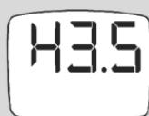
Lorsque la sécurité antivol est activée et le thermomètre non utilisé (mode veille), l'afficheur fait apparaître la durée restante avant blocage. Pour activer la sécurité antivol, reportez-vous au mode d'emploi du support chargeur.
