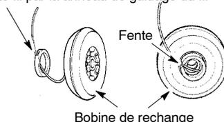
3. Posez l'anneau de guidage sur la bobine et placez le fil dans la fente. Permettez au fil de sortir de 10 à 15 cm (4 à 6 pouces) à partir du centre de la bobine.
