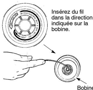
2. Insérez une extrémité du fil dans le trou au centre de la bobine vide. Assurez-vous que le fil entre dans la bobine dans la direction indiquée sur la bobine (dans le sens opposé à celui des aiguilles d'une montre).
