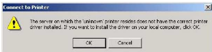
Figure 37. Windows 2000 : pas de driver d'imprimante
