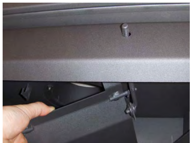
Figur 2 Bringen Sie die Sparkklappen und Schieber an
