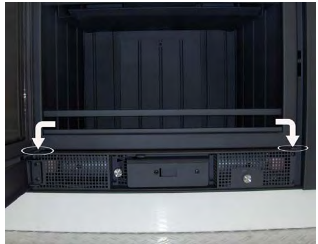
Figur 7 Entfernen Sie die 2 Schrauben unten links und rechts
