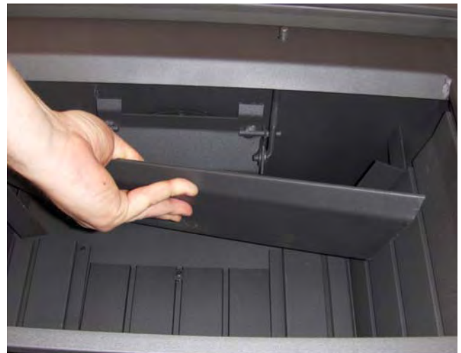
Figure 3 Pose du déflecteur des gaz de fumées dans le poêle
