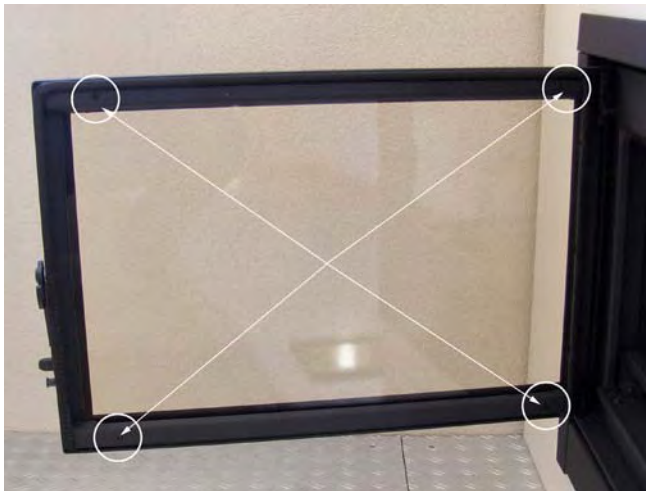
Figuur 5: Vervangen van het glas in de deur
