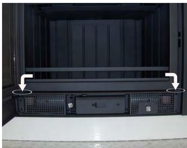
Figur 7: Enlèvement des 2 vis en bas à gauche et à droite.
