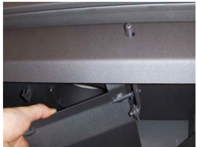
Figure 2 Mise en place du clapet économique et de la tige de poussoir
