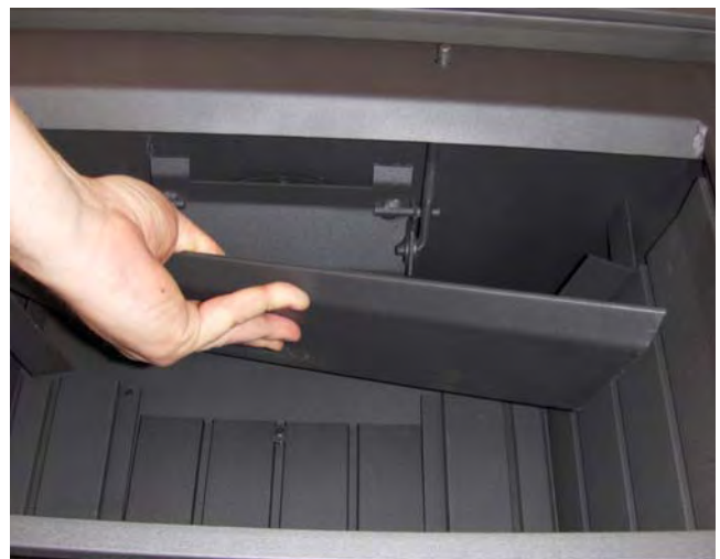
Figur 3 Legen Sie die Rauchgaskehrplatte in den Ofen
