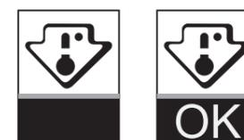
A chaque modification du thermostat, attendez la stabilisation de la température à l'intérieur de l'appareil avant de procéder si nécessaire, à un nouveau réglage. Ne modifiez la position du thermostat que progressivement et attendez au moins 12 heures avant de procéder à une nouvelle vérification et à une éventuelle modification.
