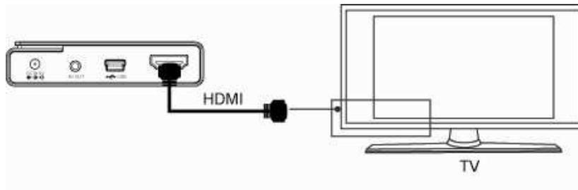
Mode de connexion de sortie de haute définition multimédia interface: Connecter le câble HDMI à la sortie HDMI du produit et à l'entrée HDMI du téléviseur. Allumer le téléviseur, sélectionner le mode HDMI. Allumer le produit, appuyer sur le bouton « TV OUT» continuellement avec des coupures de quelques secondes, le menu principal s'affiche dans le téléviseur lorsque le mode de sortie HDMI est activé
