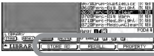
Figure 2.8: Les touches POD 2 à 4 utilisées comme touches logicielles
