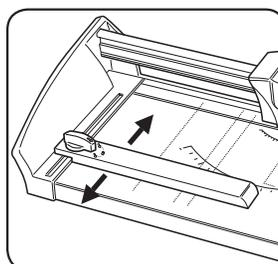
Pour effectuer les réglages requis, mettre le levier de justification sur (☐). Pour bloquer, tourner le levier de justification jusqu'à (☑).
