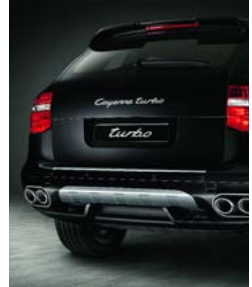
Carter de protection arrière en acier spécial
