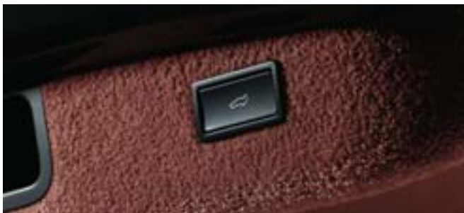
Activation du hayon automatique par simple actionnement d'une touche
