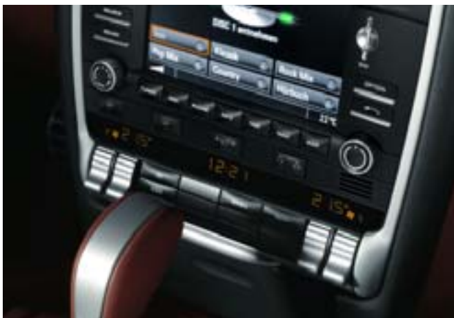
Commande de climatisation avec volet ouvert
