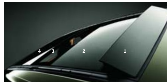
Toit panoramique ouvert à l'arrière
