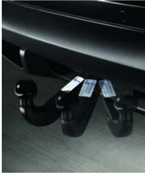
Dispositif d'attelage rétractable électriquement
