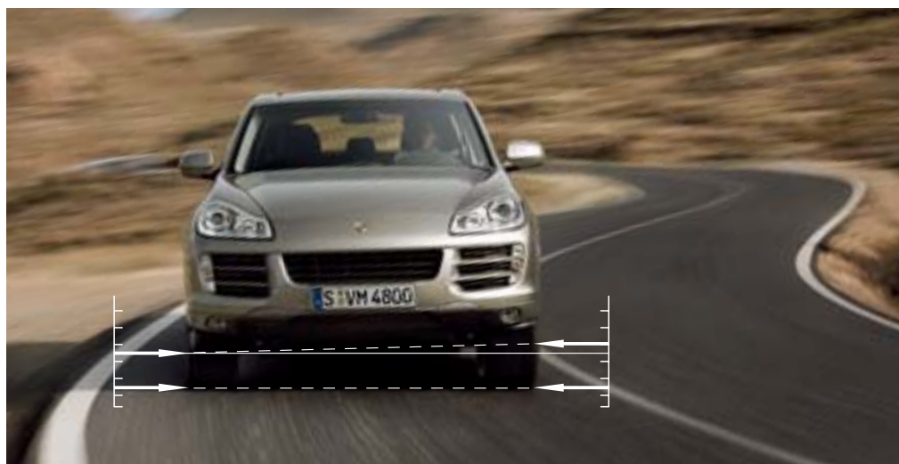
Conduite rapide en virages sans PDCC (avec graphique explicatif)
