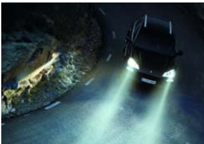
Phares avec ampoules Bi-Xénon et contrôle du faisceau en virage
