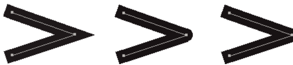
Jointures en pointes, arrondis et biseautées.
