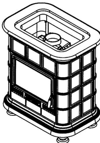
**7.** Déposer le dessus en le centrant sur l'ensemble.
