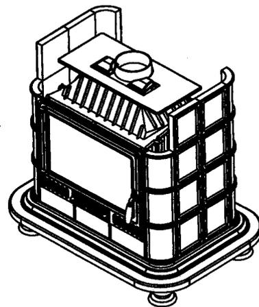
**4.** Présenter les côtés Droit et Gauche pour vérifier le décalage. Au besoin, le réglage est possible sur les 4 vis du foyer. Après cette opération, placer les côtés en les calant au moyen de la patte à joint. Déposer le déflecteur.
