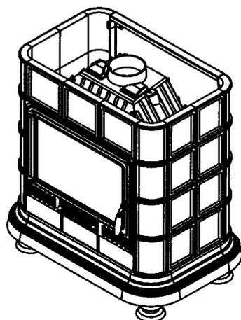
**6.** Placer le fronton en le calant au moyen de la patte à joint. Utiliser les liens pour maintenir les pièces en position. Déposer de la patte à joint sur toute la partie horizontale des éléments en céramique.
