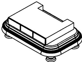
**2.** Placer la tablette en la calant avec de la patte à joint.
