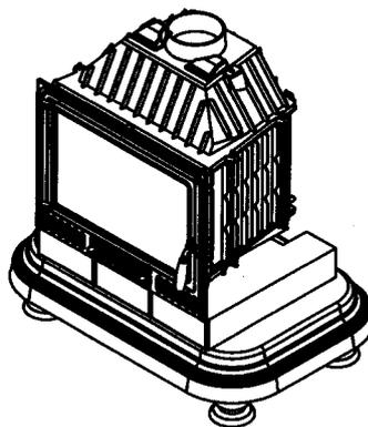
**3.** Placer le foyer et le mettre de niveau au moyen des 4 vis situées sous celui-ci.
