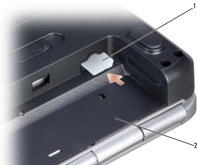
1 SIM 2 baie de batterie
