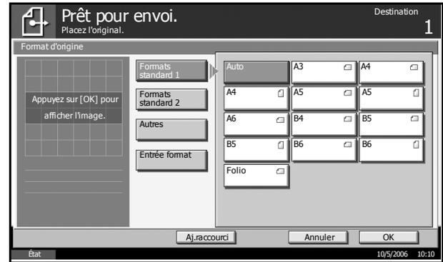
Si l'on sélectionne [Entrée format], appuyer sur [+] ou [-] pour entrer les formats X (horizontal) et Y (vertical). Appuyer sur [TouchesN°] pour utiliser les touches numériques.
