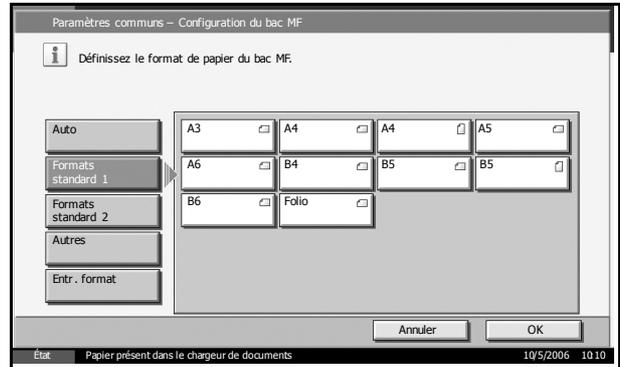
Si l'on sélectionne [Entr. format], appuyer sur [+] ou [-] pour entrer les formats X (*horizontal*) et Y (*vertical*).
