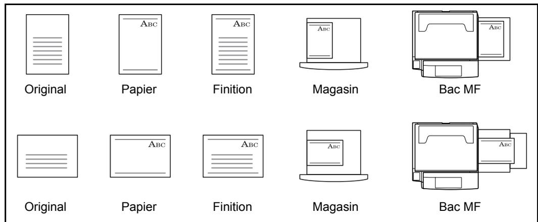
**REMARQUE :** Pour charger du papier de couverture dans un magasin ou dans le bac MF, charger la face sur laquelle l'impression doit être effectuée vers le haut.
