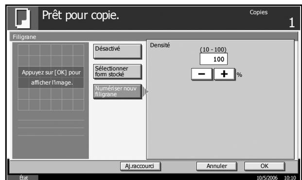
**REMARQUE :** Appuyer sur [+] ou sur [-] dans [Densité] pour définir la densité du filigrane. Il est possible de sélectionner dix niveaux par pas de 10 %.
