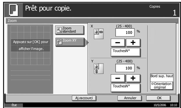
Appuyer sur [Orientation original] pour sélectionner l'orientation des originaux, [Bord sup. haut] ou [Bord sup. gche]. Appuyer sur [OK].
