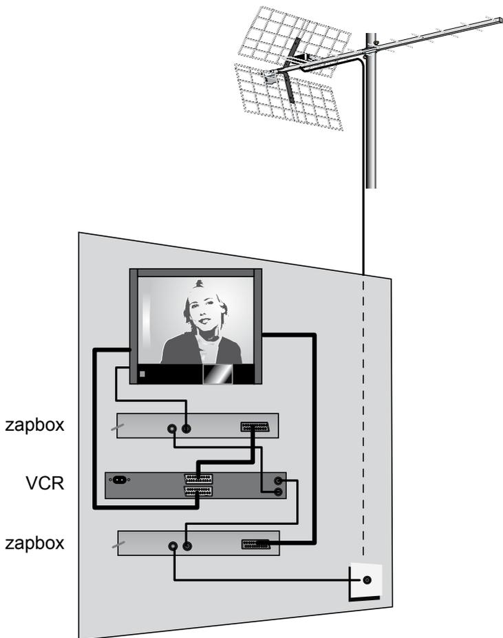
Ce schéma nécessite un téléviseur et un magnétoscope équipés tous les deux de deux péritel. Pour le fonctionnement, reportez-vous à la notice du magnéscope et du téléviseur. Vous constaterez rapidement qu'un adaptateur numérique terrestre à double tuner est plus simple à utiliser...
