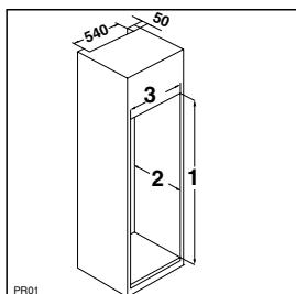
Veillez à maintenir une distance de 44 mm dans le bas de l'appareil entre le bord de l'appareil et la paroi du meuble.
