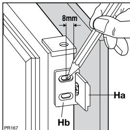
Die Winkeleisen entfernen und 8 mm vom äusseren Rand der Tür mit dem Nagel (K) kennzeichnen.
