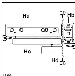
Die Schiene (Ha) auf der Innenseite der Möbeltür oben und unten aufliegen (siehe Abb.) und die Position der äußeren Bohrlöcher anzeichnen. Nachdem die Löcher gebohrt wurden, die Schiene mit den mitgelieferten Schrauben befestigen.
