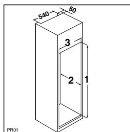
Zorg ervoor dat er een afstand van 44 mm vrij blijft tussen het keukenmeubel en de rand van het apparaat. Het onderste scharnierdeksel, dat in het zakje met accessoires zit, is handig om de exacte positie van het keukenmeubel en het apparaat te bepalen. Zorg er ook voor dat het apparaat het netsnoer niet afklemt.
