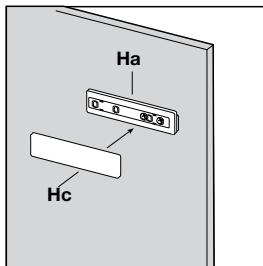
De deur van het apparaat en die van de kast met een hoek van ongeveer  $90^\circ$  openen. IJzer (Hb) in geleider (Ha) aanbrengen. De deuren samen vasthouden en de gaten aangeven zoals in de tekening.
