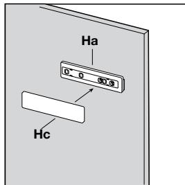
Gerätetür und Möbeltür auf ca. 90° öffnen. Den Winkel (Hb) in der Schiene (Ha) einsetzen. Gerätetür und Möbeltür zusammenhalten und die Bohrlöcher anzeichnen (siehe Abb.).
