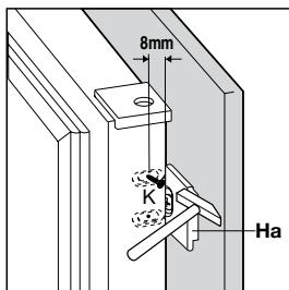
Remettre l'équerre en place sur la glissière et fixer avec les vis fournies.
