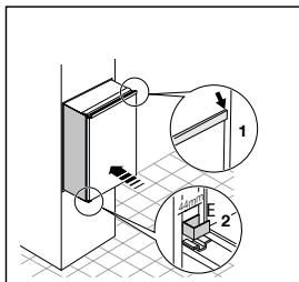
Gerät mit den 4 beiliegenden Schrauben befestigen.
