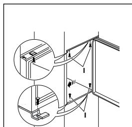
Fugenabdeckprofilen um die Winkeldicke ausschneiden und zwischen Gerät und Möbelseitenwand eindrücken.
