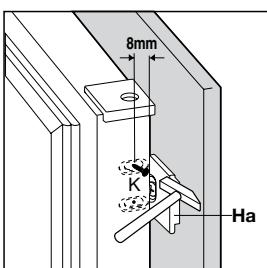
Den Winkel wieder auf der Schiene anbringen und mit den mitgelieferten Schrauben befestigen.
