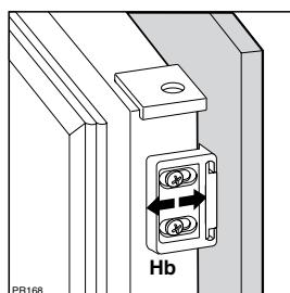
Die Abdeckung (Hd) in die Schiene (Hb) eindrücken, bis sie einrastet.
