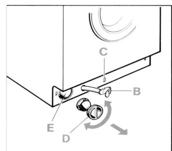
□ Dévissez le couvercle de la pompe **D** en le tournant dans le sens inverse des aiguilles d'une montre. Un peu d'eau résiduelle doit couler.
