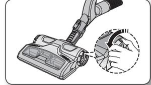
2. Une fois terminé, placez le bouton [Dust Removal] (Nettoyage) sur la position « Close » (Fermer).
