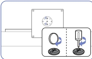
Resserez fermement la vis (à l'aide d'un tournevis ou d'une pièce de monnaie) sous le support de base.
