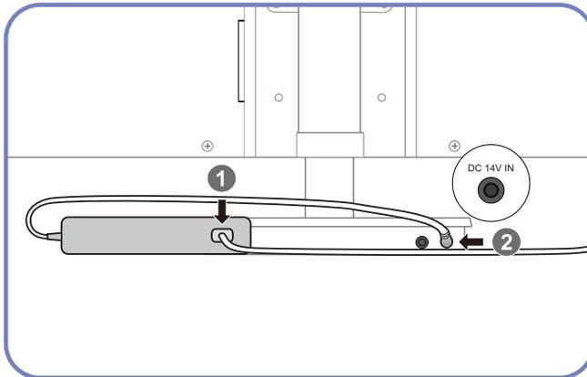
Connectez le câble d'alimentation à l'adaptateur d'alimentation CC. Ensuite, connectez l'adaptateur d'alimentation CC au port [DC 14V IN] du support de base.
