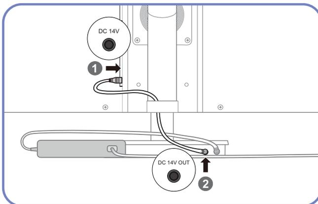
Connectez le câble d'extension au port [DC 14V] du moniteur et au port [DC 14V OUT] du support de base.
