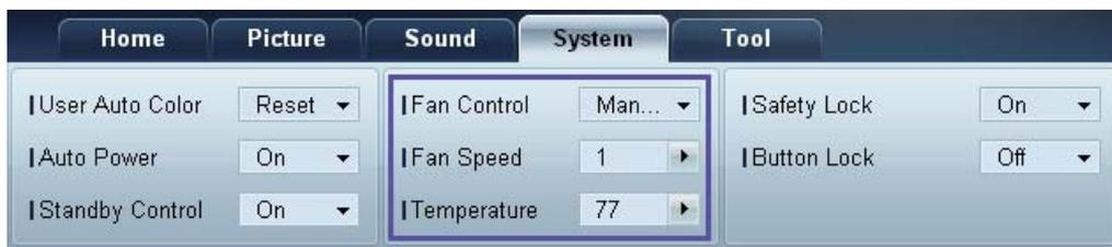
Configurez les paramètres requis pour détecter la vitesse du ventilateur et la température interne afin de protéger le produit.
