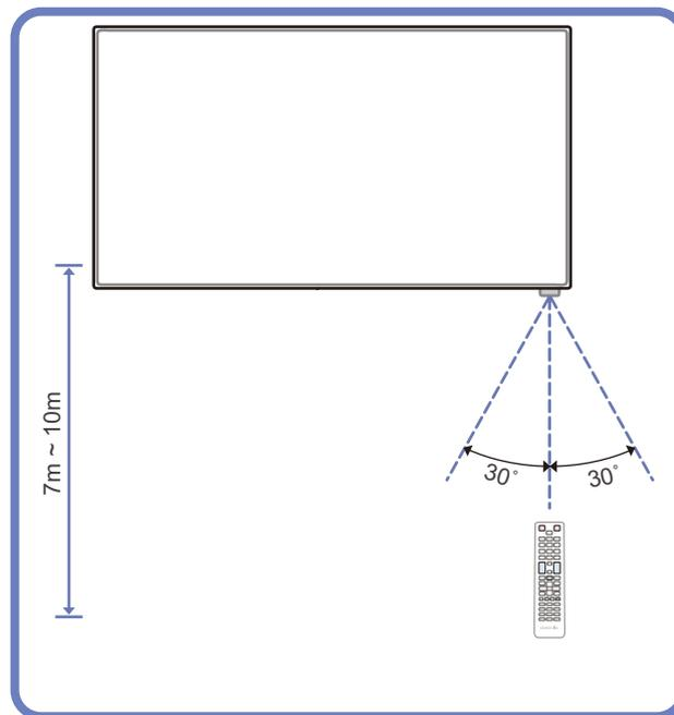
Utilisez la télécommande à une distance comprise entre 7 et 10 mètres du capteur du produit, selon un angle de  $30^\circ$  par rapport à l'axe.
