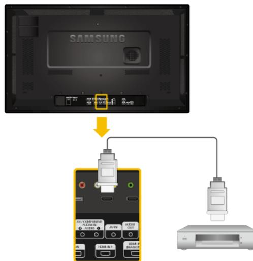
1. Connectez un câble HDMI à [HDMI IN 2 (MAGICINFO)] ou [HDMI IN 1] du produit et au port de sortie HDMI du périphérique numérique.
