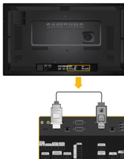
Connectez la borne [MAGICINFO OUT] et la borne [HDMI IN 2 (MAGICINFO)] de l'appareil à l'aide d'un câble DP-HDMI.
