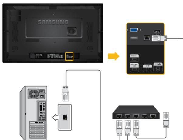
Raccordez le câble LAN au port [LAN] du moniteur et au port [LAN] du PC.
