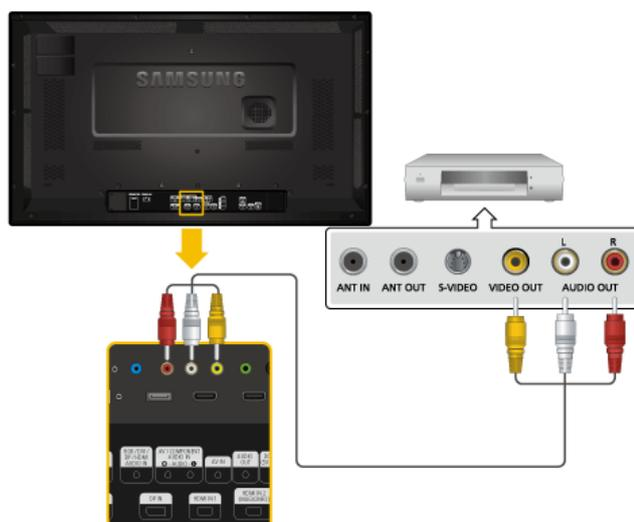
1. Connectez un câble audio à [AV/COMPONENT AUDIO IN (R-AUDIO-L)] sur le dispositif et le port audio à un dispositif externe, tel qu'un magnéscope ou un lecteur DVD.
