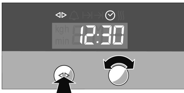
1. Appuyer sur la touche de fonction d'horloge jusqu'à ce que les symboles  $\triangleleft \triangleright$  et  $\odot$  s'allument.
