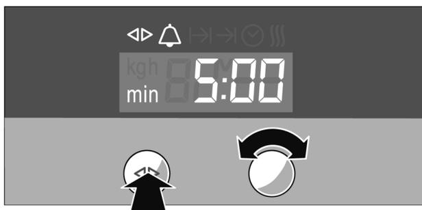
1. Appuyer sur la touche de fonction d'horloge jusqu'à ce que les symboles  $\triangleleft \triangleright$  et  $\triangle$  s'allument.
