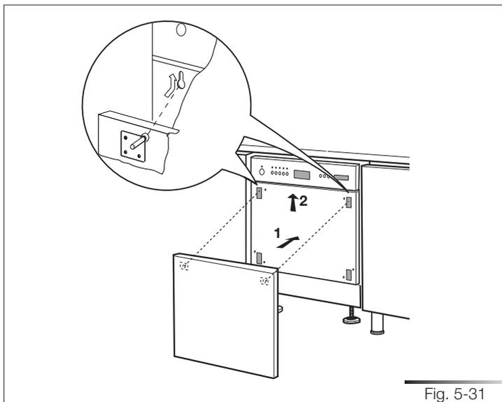
Visser la porte au panneau en utilisant les vis fournies. Le panneau doit avoir une épaisseur minimum de 20 mm (25/32") (voir fig. 5-32).
