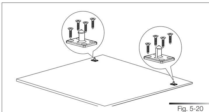
Percer les trous pour la poignée du panneau, en utilisant une perceuse munie d'un foret adapté. Avec un tournevis, monter la poignée avant de fixer le panneau au lave-vaisselle (voir fig. 5-21).
