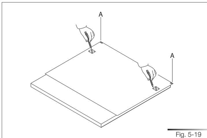
En utilisant un tournevis adapté, fixer les deux supports porte avec les 8 vis fournies (voir fig. 5-20), à visser dans les points de référence marqués précédemment.
