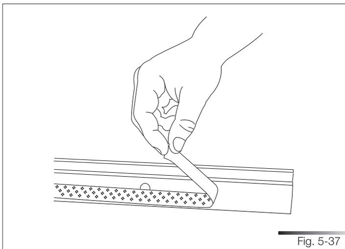
Fixer le joint sur le lave-vaisselle en l'insérant dans le siège prévu à cet effet sur les côtés de la façade (voir fig. 5-38). Veiller à ce que le côté le plus large du joint, muni du trou pour la vis, soit fixé sur le côté extérieur du lave-vaisselle ; le trou susmentionné doit coïncider avec le trou réalisé sur le lave-vaisselle (voir réf. A fig. 5-39). Contrôler que le joint adhère parfaitement au lave-vaisselle.
