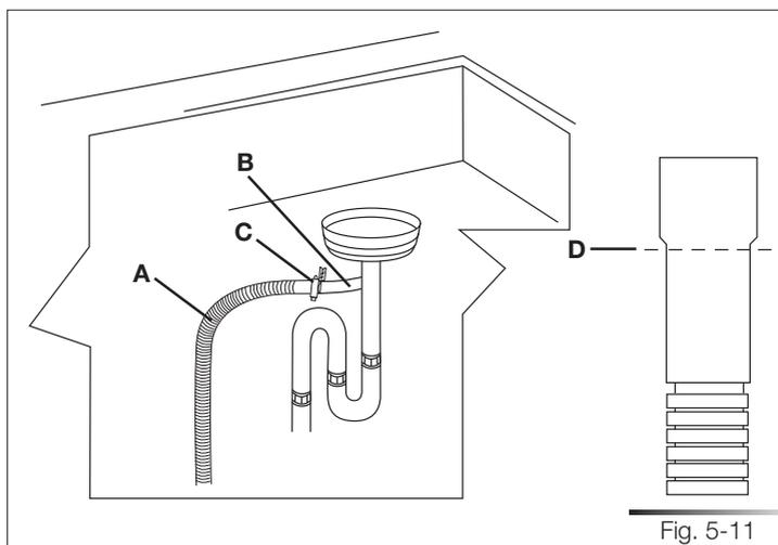
**Raccordement à un broyeur d'évier avec prise d'air**
