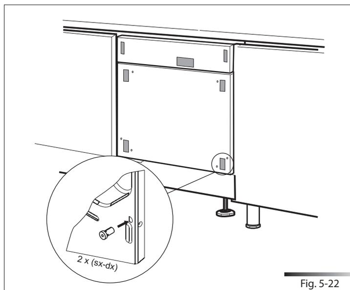
Accrocher le panneau de la porte : insérer les supports dans les sièges prévus à cet effet sur le lave-vaisselle, puis laisser le panneau glisser vers le bas, de façon à ce qu'il s'encastre (voir fig. 5-23).
