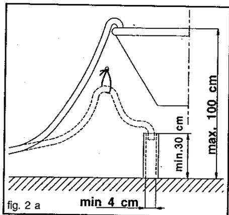
Avec les tuyaux de rallonge qui doivent être **placé horizontalement** pour longueur maximum de **3 mètres**, la **hauteur maxi** admise pour le raccordement au tuyau de vidange est de **85 cm**.
