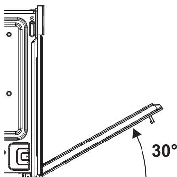
Pour remonter la porte, introduisez les charnières dans les fentes prévues à cet effet sur le four en s'assurant que les rainures **C** sont complètement posées contre les fentes. Abaissez la porte puis sortez les pivots des trous des charnières.
