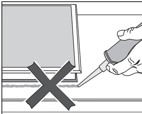
La bande sous le rebord de la table de cuisson garantit une étanchéité suffisante par rapport au plan de travail.
