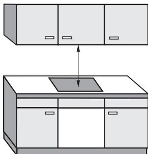
La distance de sécurité entre la hotte et la table de cuisson prescrite par le fabricant de la hotte doit être respectée. Si vous ne disposez pas d'indications du fabricant à ce sujet ou si des matériaux inflammables sont montés (porcelaine par exemple) au-dessus de la table de cuisson, la distance de sécurité doit être d'environ 760 mm minimum.
