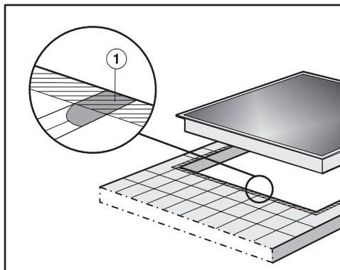
Les joints ① et la zone hachurée sous la surface de support de l'appareil doivent être lisses et égaux afin que le cadre repose bien sur les bords et que le joint d'étanchéité situé sous le rebord de la partie supérieure de la plaque puisse assurer une étanchéité suffisante avec le plan de travail.
