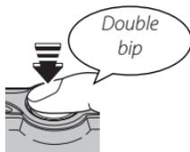
**Si l'appareil photo parvient à faire la mise au point**, il émet deux bips et un témoin lumineux vert s'allume.
