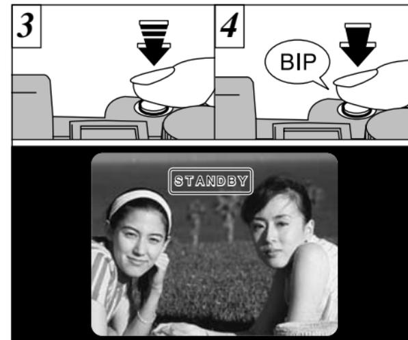
Appuyez à mi-course sur le déclencheur (AF mémorisé) et vérifiez si "STANDBY" est affiché sur le moniteur LCD (ou si le témoin vert du viseur s'arrête de clignoter et reste allumé). Avec le déclencheur toujours à mi-course (AF mémorisé), déplacez l'appareil photo vers l'image de départ et appuyez à fond sur le déclencheur.
