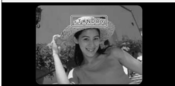
Appuyez sur le déclencheur à mi-course. Si "STANDBY" apparaît sur le moniteur LCD (si le témoin vert du viseur s'arrête de clignoter et reste allumé), l'appareil photo est mis au point.
