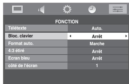
Lorsque le **Bloc. clavier** est défini sur **Marche**, un rappel apparaîtra à l'écran si vous tentez d'utiliser les touches du téléviseur. **Si vous appuyez sur la touche de veille, le téléviseur s'éteindra et ne pourra être rallumé qu'en utilisant la télécommande.**
