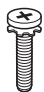
Parafusos do suporte 4EA, M4 x 16 (Apenas LA860*, LA868*) (Consulte a p. A-3, A-4)
