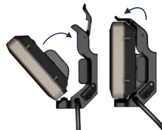
Insertion du GPSMAP 620 dans le support de montage
