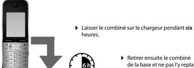
de la base et ne pas l'y replacer avant que la batterie ne soit complètement déchargée.
