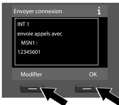
La liaison d'émission actuellement réglée pour la base est affichée : **MSN1** pour les connexions au réseau RNIS et **Ligne fixe** pour les connexions du Gigaset DX800A all in one à la ligne fixe analogique.
