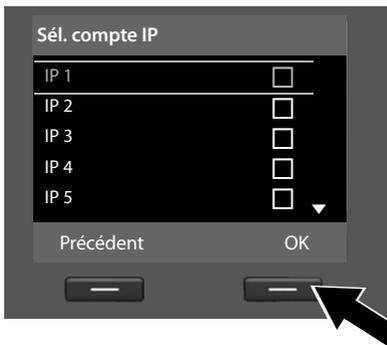
La liste répertoriant l'ensemble des connexions IP possibles s'affiche à l'écran (de IP 1 à IP 6). Les connexions VoIP déjà configurées sont signalées par une coche .
