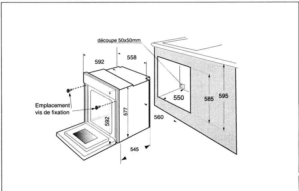
**Ovnen er beregnet til indbygning under et køkkenbord eller i et (åbent\* eller lukket) skabselement med bestemte mål (se skemaet).**
