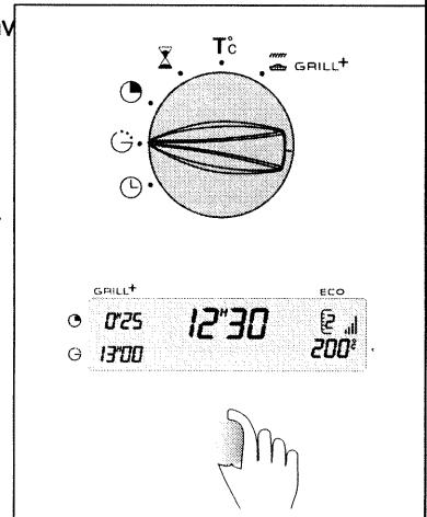
Efter dessa åtgärder är värmningstidens starttidpunkt framskjuten så att stekningen/gräddningen avslutas kl 13h00. När din stekning/gräddning är avslutad, avges en serie pipljud; återställ stekning/gräddningsväljaren på "0".
