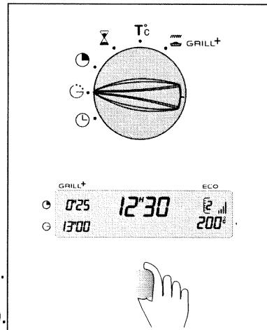
Herefter tænder ovnen på et tidspunkt, der svarer til, at tilberedningens sluttidspunkt bliver kl. 13.00. Indstil funktionsvælgeren på "0", når tilberedningen er slut, og der høres en række biplyde.
