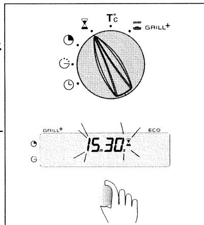
Displayet holder op med at blinke efter et par sekunder, og timeren tænder. Nedtællingen af tilberedningstiden begynder med intervaller på et sekund. Når den indstillede tid er gået, udsender timeren en række biplyde.
