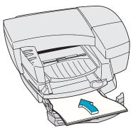
4 Placez une pile de papier, de transparents ou d'enveloppes, côté impression vers le bas, dans le bac de sorte que le côté droit de la pile soit contre le côté droit du bac. Le bac à papier optionnel peut contenir jusqu'à 250 feuilles de papier (pile de 26 mm d'épaisseur maximum).
