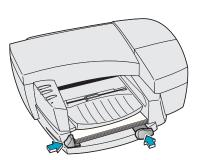
Chargement du support dans le bac à papier optionnel de l'imprimante HP 2000C Series
