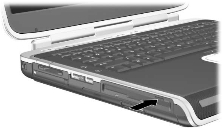
Identification du bouton d'éjection sur une unité de disquette
