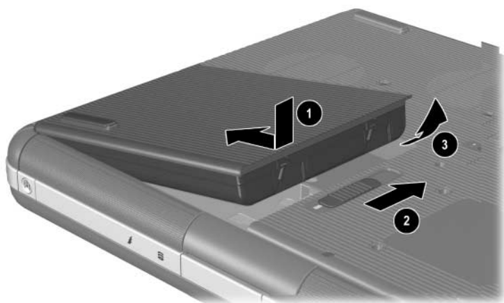
Insertion ou retrait du module batterie
