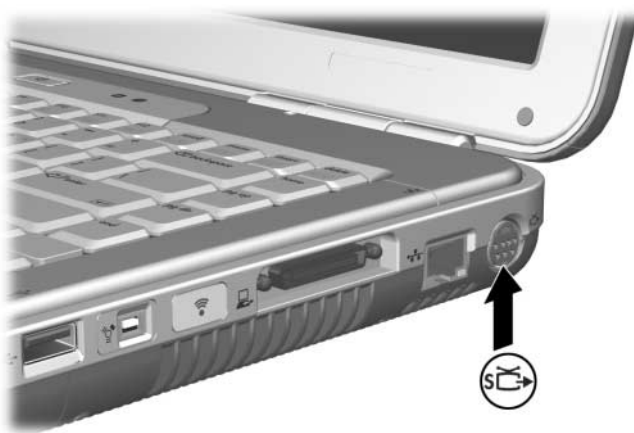
Identification de la prise de sortie S-vidéo
