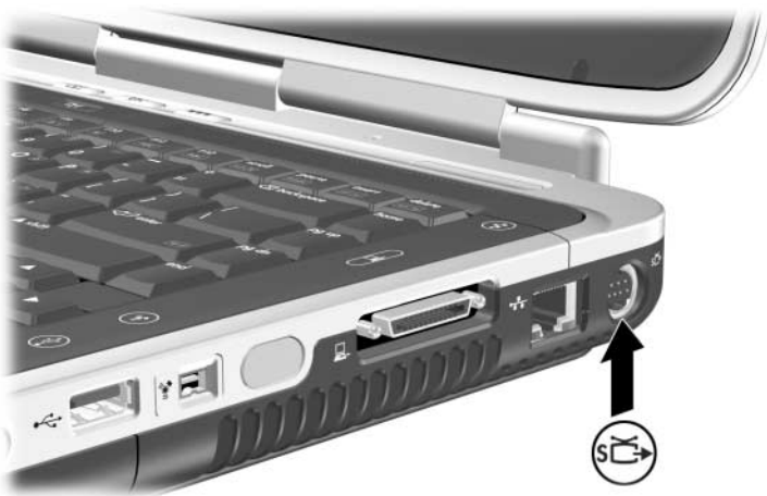
Identification de la prise de sortie S-vidéo
