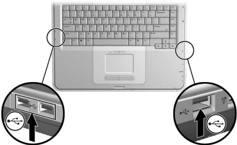
Identification des deux connecteurs USB du côté gauche et de l'unique connecteur USB du côté droit
