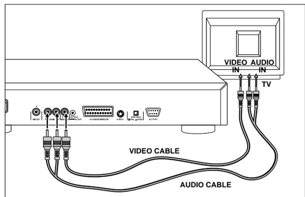
Connexion à un téléviseur à l'aide d'une prise vidéo (CVBS).
