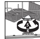
Insérez et serrez à fond les bras d'aspersion supérieur et
