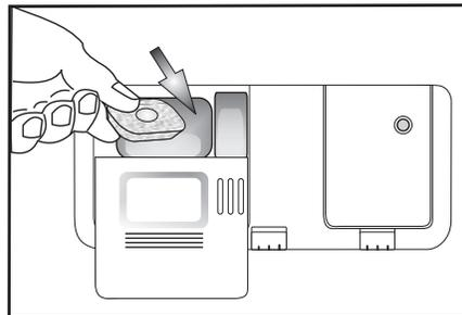
Utilisez une seule tablette par cycle ; placez-la dans le distributeur de détergent. Tous les types de tablettes peuvent être utilisés ; cependant, pour les tablettes 2 en 1, il FAUT approvisionner en sel. Certains types de tablettes ne se dissolvent pas complètement pendant les programmes de lavage courts (Court, Fragile, Lavage main) ; le fait de placer la tablette au fond de la cuve peut favoriser la dissolution et le lavage.
