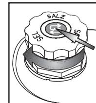
Vissez le bouchon. Éliminez les résidus de sel autour du bouchon. Certains réservoirs à sel ont un indicateur de niveau intégré dans le bouchon (voir la méthode de contrôle ci-dessous).
