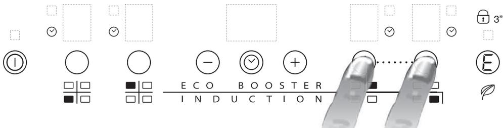
Pour modifier le niveau de puissance, appuyez sur les touches - / + (De 1 à un maximum de 9 ou P). Pour désactiver la fonction Flexi cook, appuyez simultanément sur les 2 touches de sélection des foyers. Pour éteindre instantanément les deux foyers, maintenez l'une des touches de sélection des foyers enfoncée pendant 3 secondes.
