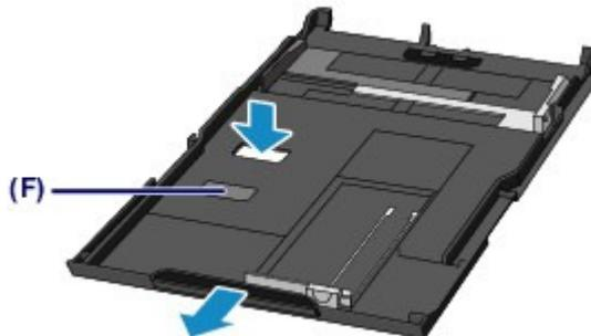
La cassette (inférieure) dépasse légèrement de la machine lorsqu'elle est correctement installée. Ne forcez pas pour insérer davantage la cassette (inférieure) dans la machine. Vous risqueriez d'endommager la machine ou la cassette (inférieure).
