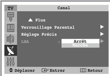
*Cette fonction est très utile lorsque le téléviseur fonctionne dans une zone où le signal est faible. Elle amplifie le signal du téléviseur, mais pas le bruit.*
