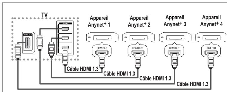
A l'aide du câble HDMI, reliez la prise [HDMI IN 1], [HDMI IN 2], [HDMI IN 3] ou [HDMI IN 4] du téléviseur à la prise HDMI OUT de l'appareil Anynet+ correspondant.
