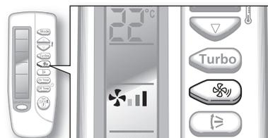
En appuyant sur le bouton **Vitesse du ventilateur**, la vitesse du ventilateur change dans l'ordre suivant : Auto, Low(Faible), Medium(Moyenne), High(Elevée).
